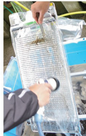
第4図 根系のピンボードへの固定。 ピンボードの土壌と根系への押し挿し (a), 根系を含んだ土壌からの根箱の取り外し (b), シート片面上の土壌の洗い流し (c).
